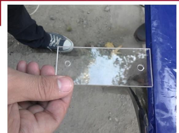
Placa perforada con broca de 5mm que servirá para montar antena y tensarla con piolas.
