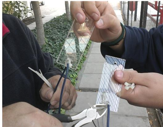
Las medidas ya tomadas nos sirven para ubicar las placas para montaje de la antena en altura y las puntas en cada extremo serán para la conexión del conector N hembra.
