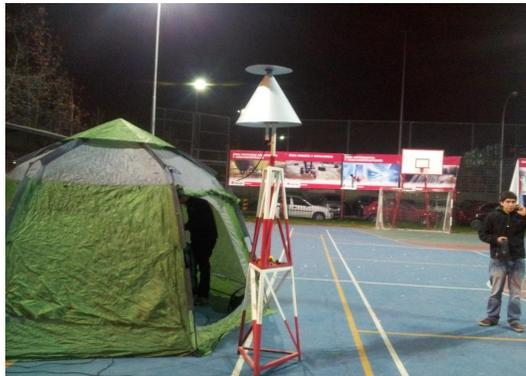
Figura 27: Discono montado y listo para pruebas.
