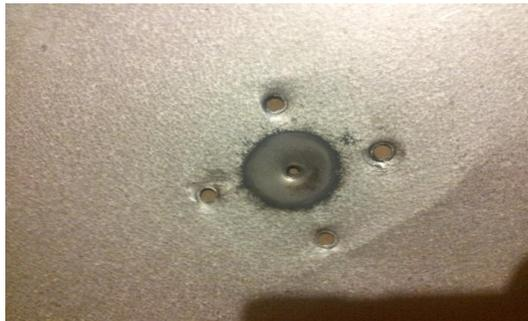
Figura 25: Aluminio limpio y listo para soldar.
