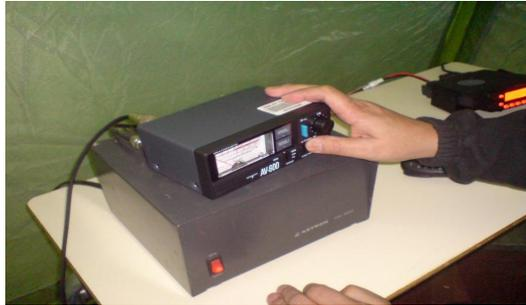
Figura 26: Equipo para medición del ROE.
