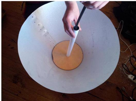
Figura 21: Montado del acrílico dentro del discono.
