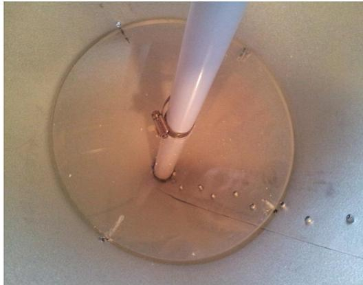
Figura 23: Pieza acrílica fijada al disco mediante tornillos.
