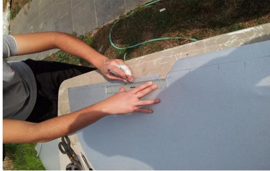
Figura 12: Marcar el cono en las posiciones de los remaches.
