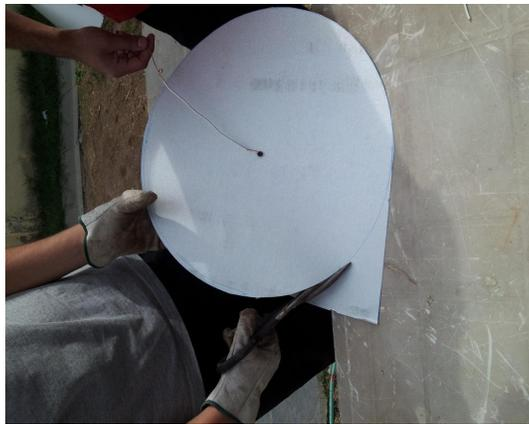
Figura 11: Cortando disco de la antena.
