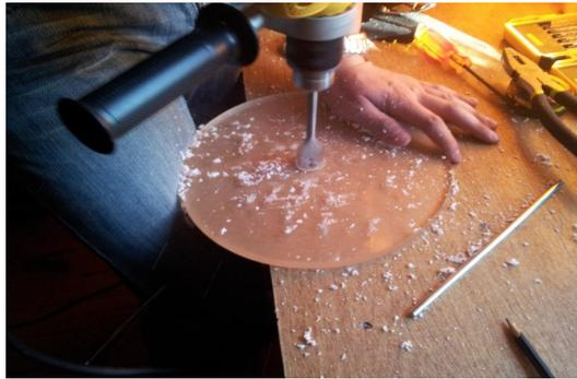
Figura 20: Perforación del acrílico para inserción del mástil.
