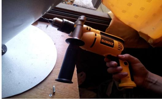
Figura 22: Perforación al disco y a la pieza acrílica para su fijación.
