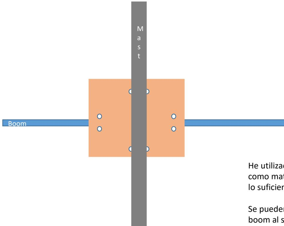
He utilizado una placa Pertinax de 5 mm de espesor como material de soporte, pero cualquier material lo suficientemente rígido está bien.
